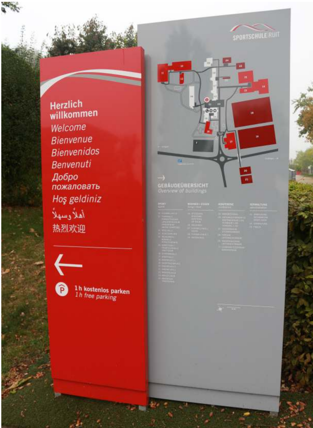
Unbeleuchteter Pylon, Material: Aluminium (lackiert), Folienbeschriftung, Siebdruck
