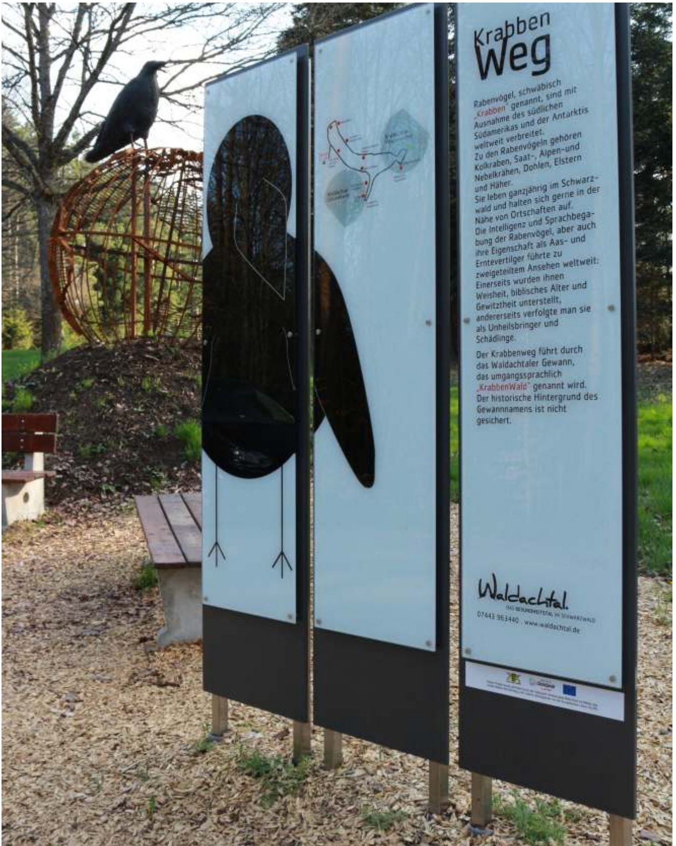
Unbeleuchteter Pylon, Material: Aluminium (lackiert),Edelstahl, Echthglas, Folienbeschriftung: Digitaldruck
